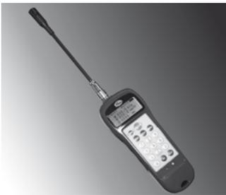
Le tensiomètre sonique opère par l'analyse des ondes sonores produites par une courroie qui vibre. Une courroie vibre à une certaine fréquence, déterminée par sa tension, sa masse et par la longueur du brin. Le tensiomètre traduit cette fréquence en une valeur de tension. Ce tensiomètre
