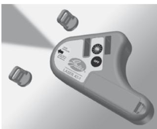
Le LASER AT-1 détecte le désalignement parallèle et angulaire des poulies et peut être utilisé pour des diamètres de poulies de 60 mm et plus. Cet outil est installé en quelques secondes et le rayon laser projeté sur les "cibles" vous permet de contrôler et de corriger rapidement l'alignement. Il
