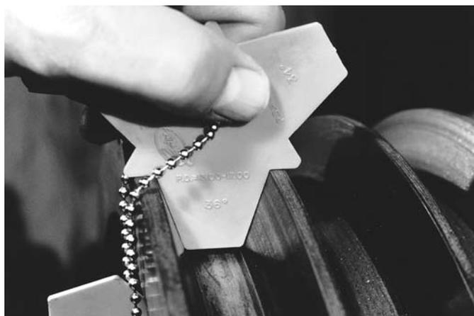
*Les calibres pour poulies Gates facilitent la recherche de l'usure.*
