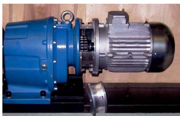
Bride **type A** avec inspection pour le contrôle et l'étalonnage du limiteur de couple.
