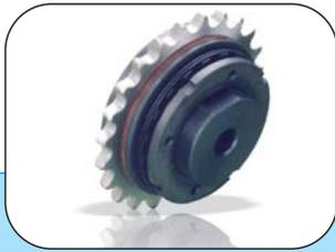
Dispositif de sécurité avec le pignon monté entre deux anneaux de friction qui glissent sans débrayer lorsque le couple de tarage est atteint.
