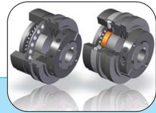
Dispositif de sécurité avec la transmission par des billes ou des rouleaux qui se dégage complètement au couple de tarage fixé.
