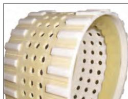
Des supports spéciaux peuvent également être usinés pour optimiser le rendement des courroies dans des applications spéciales. Un exemple caractéristique est le fraisage creux du support pour créer un « effet ventouse » et maximiser l'aspiration fournie par les découpes au jet d'eau. Dans ce cas, l'aspiration parfaite est également garantie par l'absence d'éléments de tension dans les zones de vide.
