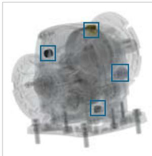
4 bouchons interchangeables de série, dont un du niveau et un reniflard. Noter que le bouchon reniflard permet également de réduire la pression interne sur les joints, et donc d'augmenter le rendement du réducteur.
