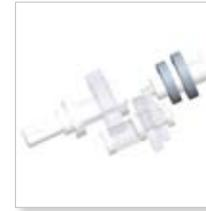
Un double support à roulements de l'arbre d'entrée assure un alignement correct des engrenages du premier stade, réduit les vibrations et augmente la durée de vie du pignon et de la bague
