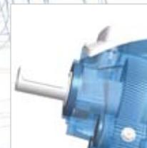
Une saillie réduite entre l'arbre de sortie et le dernier roulement augmente la capacité de soutien des charges radiales.
