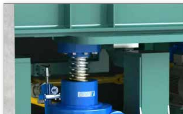
Pfaff-silberblau – Installation de levage de 500 tonnes pour déplacer des fours à zinc
