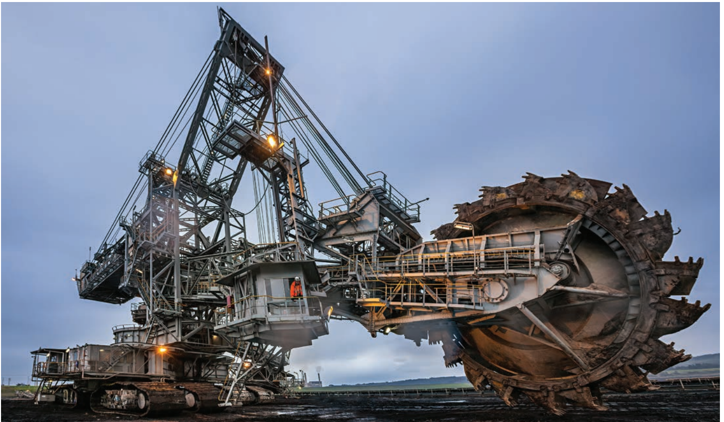
Excavatrice de carrière : frette SIT-LOCK® 4 COMPACT pour les tambours et frette SIT-LOCK® 14 pour le blocage de la roue du godet.
